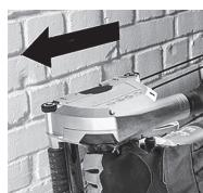
**Внимание!** Винаги натискайте машината в определената посока през материала, който ще се обработва! Вижте стрелката (11) на предпазителя. Дискът може да се огъне, да се приближи или да направи откат, ако електроинструментът се рестартира в детайла за рязане.
