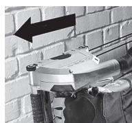
A gépet mindenkor előírt irányban kell tolni a megmunkálálandó anyagban! Lásd a védőburán látható nyílat (11). **Ellenkező esetben a tárcsa megakadhat, kiugorhat a munkadarabból, vagy visszacsapódást okozhat.**
