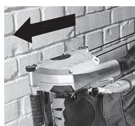
Prístroj vždy tlačte v stanovenom smere cez materiál, ktorý sa má spracovať! Pozrite šípku (11) na ochrannom kryte. Ak elektrické náradie znova spustíte v obrobku, môže dôjsť k uviaznutiu, výdeniu alebo spätnému nárazu kotúča.
