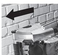
Die Maschine immer in der vorgeschriebenen Richtung durch das zu bearbeitende Material schieben! Siehe Pfeil (11) auf der Schutzhülle. Andernfalls kann die Scheibe verhaken, aus dem Werkstück springen oder einen Rückschlag verursachen.
