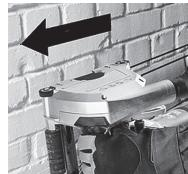
Skyv alltid maskinen i foreskrevet retning gjennom materialet som skal bearbeides! Se pilen (11) på beskyttelseshetten. Ellers kan skiven sette seg fast i overflaten, sprete ut av emnet eller det kan oppstå rekul.
